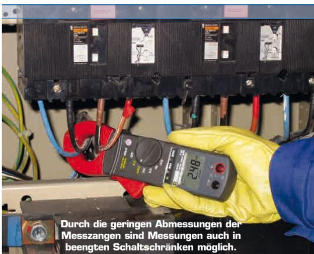
Durch die geringen Abmessungen der Messzangen sind Messungen auch in beengten Schaltschrank möglich.
